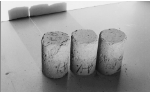
Photo n° 2 – État des mêmes éprouvettes après 6 cycles d'immersion-séchage.
