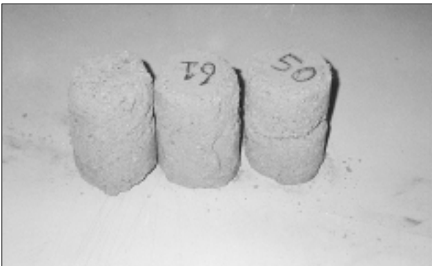
Photo n° 3 – État des mêmes éprouvettes après 7 cycles d'immersion-séchage. Elles ne sont plus aptes à subir un essai de compression simple.
